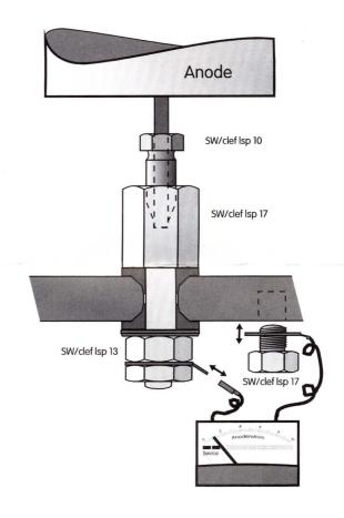
4. L'anode proprement dite est boulonnée intérieurement à un contre-support. Retenir ce boulonnage isolant intérieurement avec une clef lsp 17. Desserrer la vis conique lsp 10 avec le fil de l'âme de l'anode. Une clef plate large ou une clef plate à molette bien réglée devrait être utilisée de manière à protéger les surfaces du 6-pans. L'anode peut alors être vissée et serrée. Un contact annulaire s'établit du fait de ce montage à l'avant entre l'anode et le raccord.
