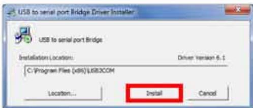
Après apparition de la fenêtre d'installation du programme et pilote USB cliquer sur « installer » pour continuer. Les systèmes d'exploitation comme Vista ou Windows 7 peut apparaître une fenêtre sur l'authentification du conducteur. Laissez l'installation se poursuivre, en dépit de cette fenêtre.
