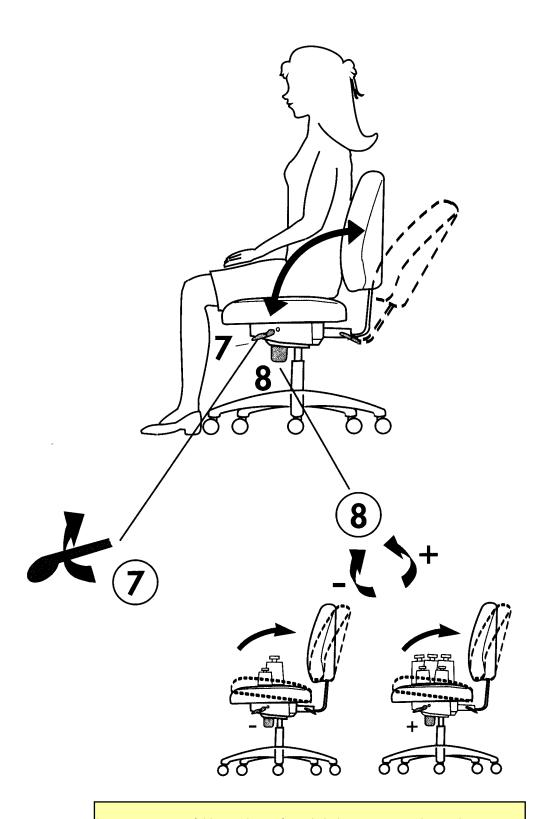
La manette 7 sert à bloquer le système de balancement synchrone dans une position donnée.
