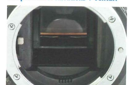
L'antipoussière est basé non seulement sur une classique mise en vibrations de la lame de protection du capteur, mais aussi sur la "recirculation" des poussières hors de la chambre durant l'exposition.
